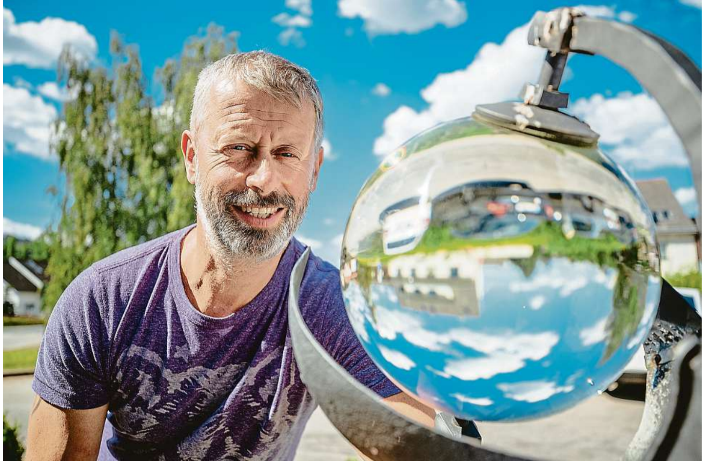
Loděnický heliograf Před areálem firmy Ginzel, s. r. o., stojí ocelový držák se skleněnou koulí. „Je to heliograf. Zařízení na měření délky slunečního svitu. Když svítí slunce, vypálí se v ohniskové vzdálenosti na nehořlavý papír za koulí čárka,“ vysvětluje Martin Ginzel. Foto: Petr Topič, MAFRA
